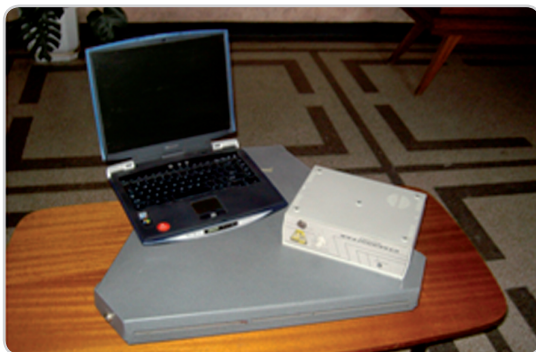
Фиг. 14. Компютризирана стабилографска система
